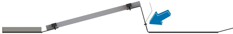
Bei der Installation des Potentialausgleichs darauf achten, dass keine Kontaktkorrosion zwischen Montagesystem und Erdungsanlage entsteht. Die Firma Alumero übernimmt keinerlei Haftung für Schäden die durch Blitzeinschläge oder Erdungsprobleme entstehen können.
